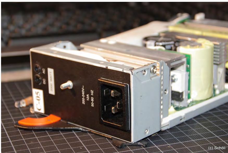
Bild 13: Netzbuchse vor dem Ausbau
